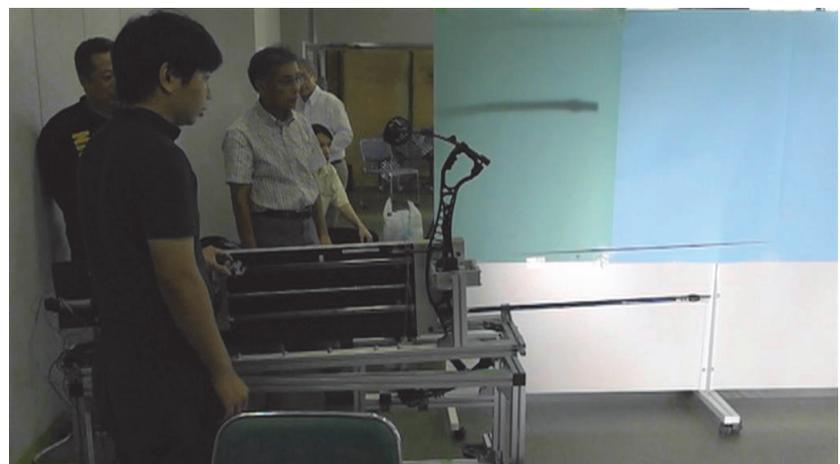
図3 コンパウンドボウによる矢の飛翔実験の様子
