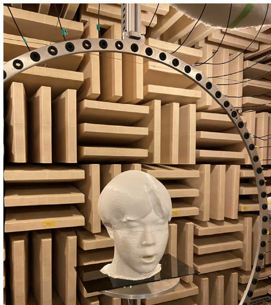
図1 疑似頭の放射特性の測定の様子
