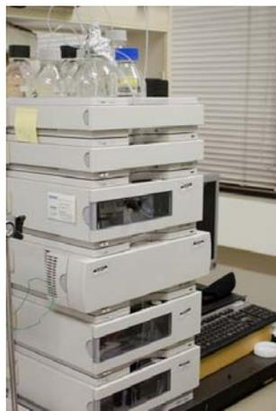
ヤコウタケなどの発光生物から抽出した有機化合物、また有機合成した生成物などの微量サンプルを分離、精製するのに使用します。
