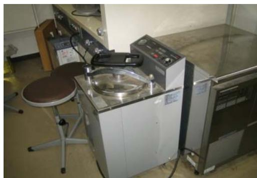
高温・高圧下で水蒸気によって滅菌する装置です。ヤコウタケの培地の滅菌に使用します。
