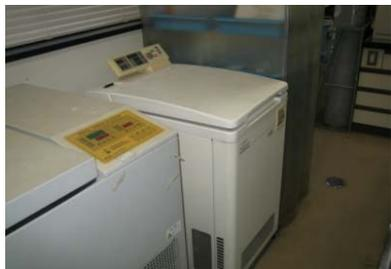
試料に大きな遠心力をかけることにより、その成分を分離することができます。さらに、この実験室にある遠心分離機は温度も設定できるため、熱に弱いタンパク質を扱う際などには重宝されます。
